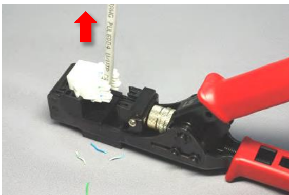
5. Saque el Módulo Jack verticalmente desde la herramienta.
