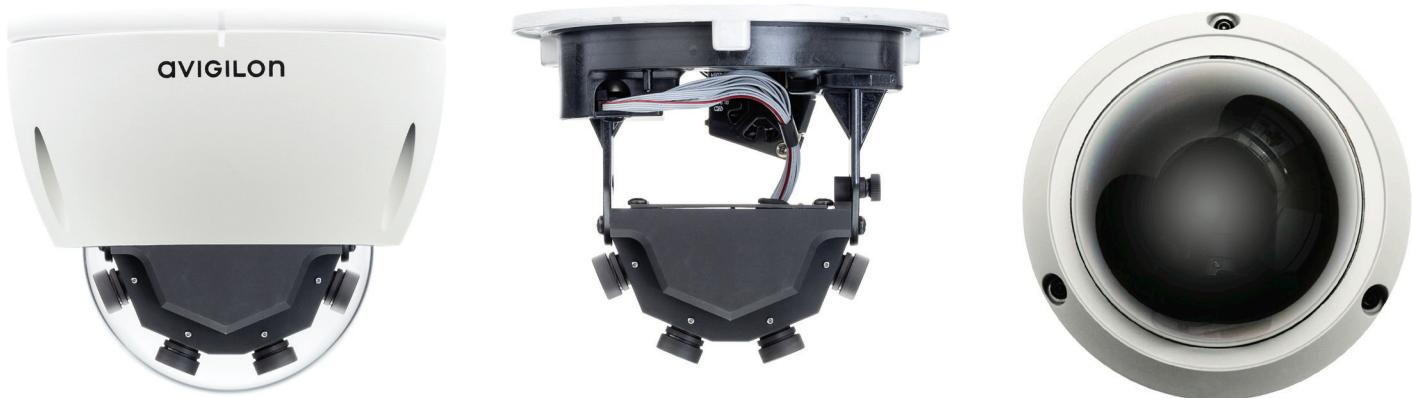
Las cámaras panorámicas domo HD JPEG2000 tienen 4 sensores de 2 MP y ofrecen una resolución total de 8 MP. Una única instalación proporciona una cobertura de alta resolución de 180° con objetivos preenfocados que facilitan la instalación. Esta cámara es ideal para supervisar entornos interiores o exteriores para los sectores de educación, banca, venta al por menor, alojamiento y hostelería, o para cualquier lugar en el que los puntos de instalación sean limitados.
